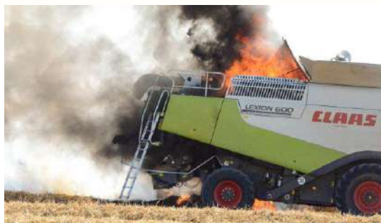
Feu de courroies échauffées sur des roulements coincés
